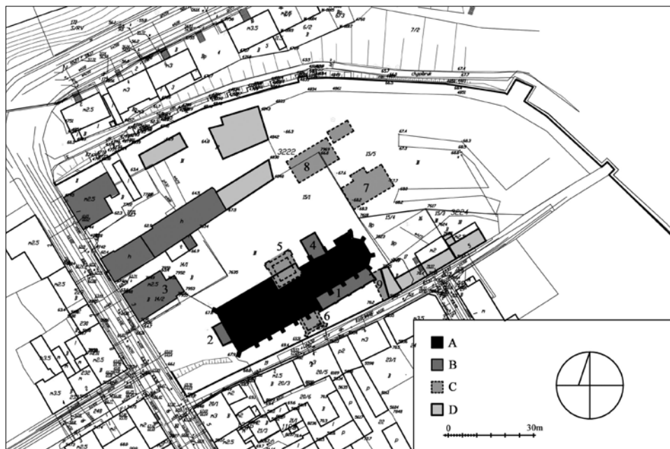
II. 3. Plan zrealizowanych i planowanych budynków na terenie dawnego klasztoru Dominikanów w Chełmnie. Objaśnienia: A. kościół pw. śś. Piotra i Pawła; B. budynki istniejące; C. budynki projektowane; D. budynki przebudowane; 1. Nowa neogotycka zakrystia z lat 1883–1884; 2. Przebudowana neogotycka kruchta z 1892 r.; 3. Pastorówka przy ul. Wodnej z 1899 r.; 4. Kotłownia ze składem węgla z 1912 r.; 5. Projekt wieży z 1884 r.; 6. Projekt wieży z 1890 r.; 7. Projekt „drugiej” pastorówki z 1904 r.; 8. Projekt pastorówki z 1887 r.; 9. Projekt latryny z 1912 r. (rys. P. Samól).
